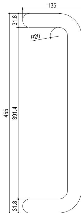
Asa em Inox 316 para uma melhor performance e resistência anti- corrosiva.
