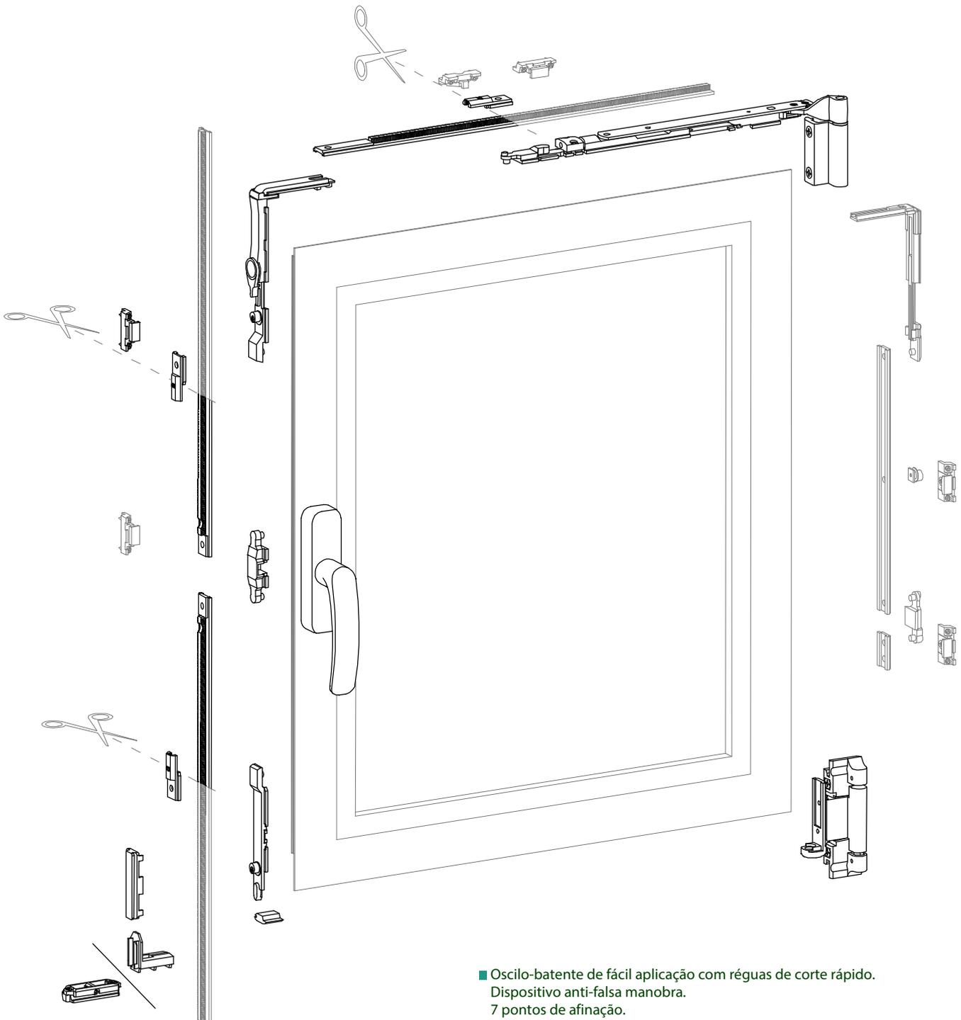
■ Oscilo-batente de fácil aplicação com régulas de corte rápido.
