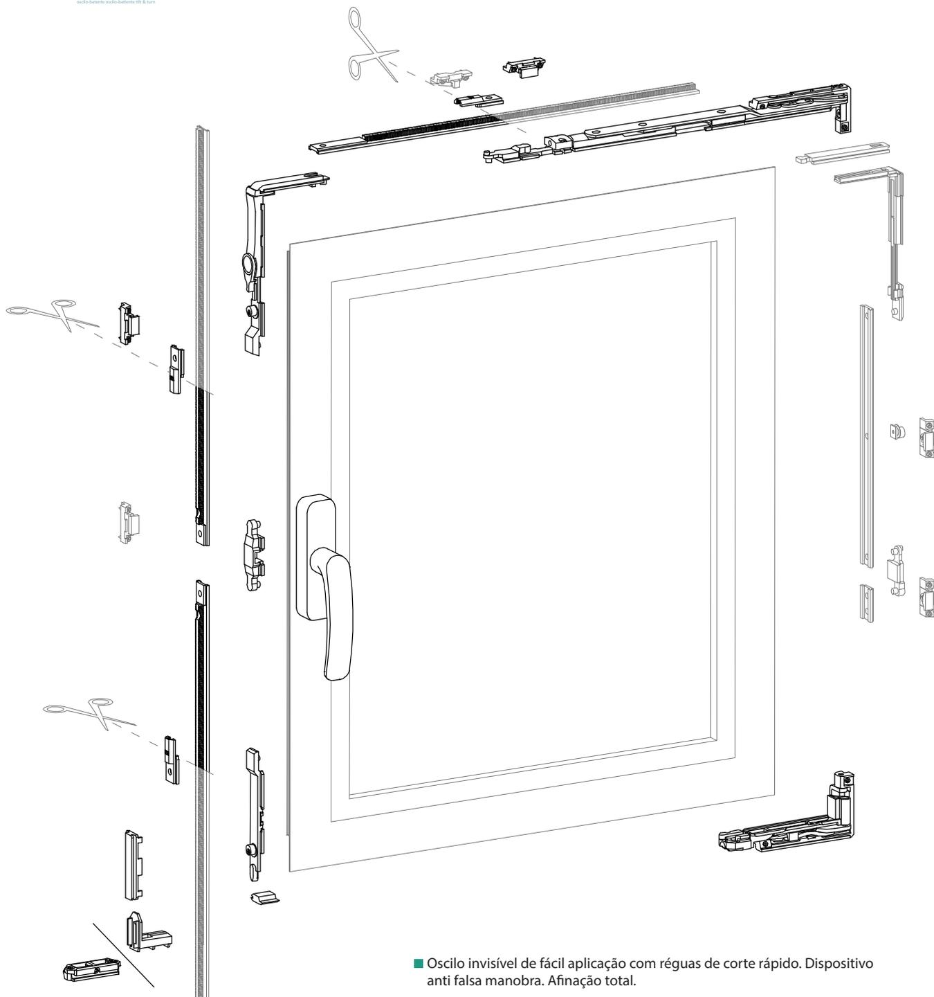
■ Oscilo invisível de fácil aplicação com régulas de corte rápido. Dispositivo anti falsa manobra. Ajustagem total.
