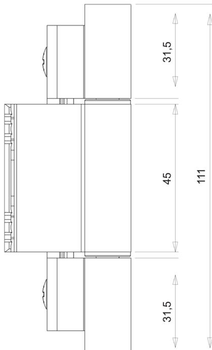
■ Dobradiça em alumínio para perfis em alumínio de canal europeu. Recomendada para quando se verificam forças transversais. Desenvolvida para suportar cargas elevadas. Fiel em inox 304.
